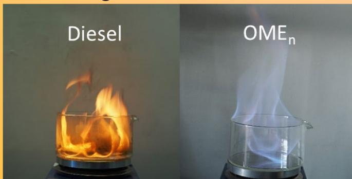
**Oxymethylenether (OME)** lösen dieses Problem, indem bei der Herstellung des Kraftstoffes, nicht Kohlenstoffatom an Kohlenstoffatom gereiht wird, sondern immer ein **Kohlenstoffatom im Wechsel mit einem Sauerstoffatom**. Dadurch kann kein Ruß entstehen.
