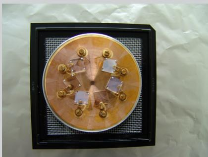
Im Fertigungsprozess entstehen so genannte TCO-Schichten (Transparent Conductive Oxide), die die Doktorandin mit verschiedenen Charakterisierungsmethoden analysiert. Diese helfen ihr, die optischen, elektrischen und strukturellen Eigenschaften zu beurteilen.
